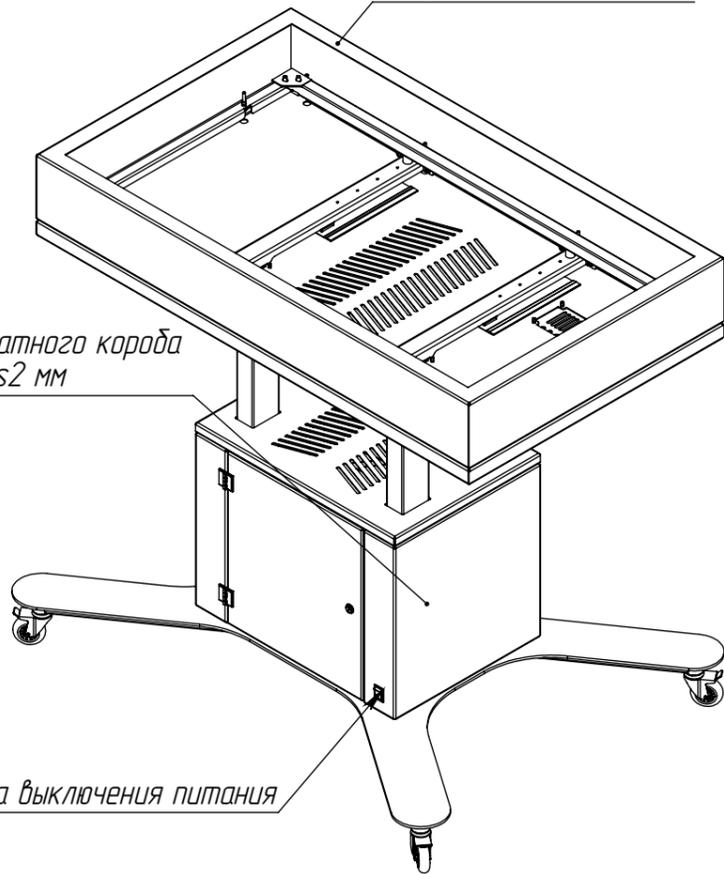
Корпус аппаратного корпуса из алюминия s2 мм
