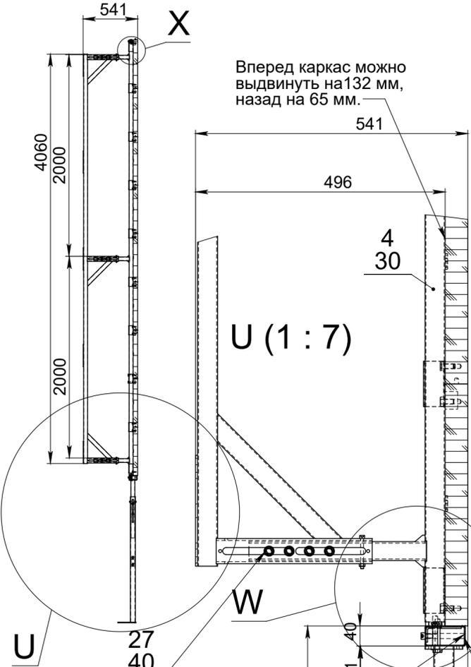
Вперед каркас можно выдвинуть на 132 мм, назад на 65 мм.
