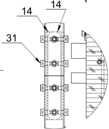
Нижняя сборка труб для облегчения выставления 1 ряда панелей (после окончательного закрепления всей видеостены возможен демонтаж этих нижних труб.)
