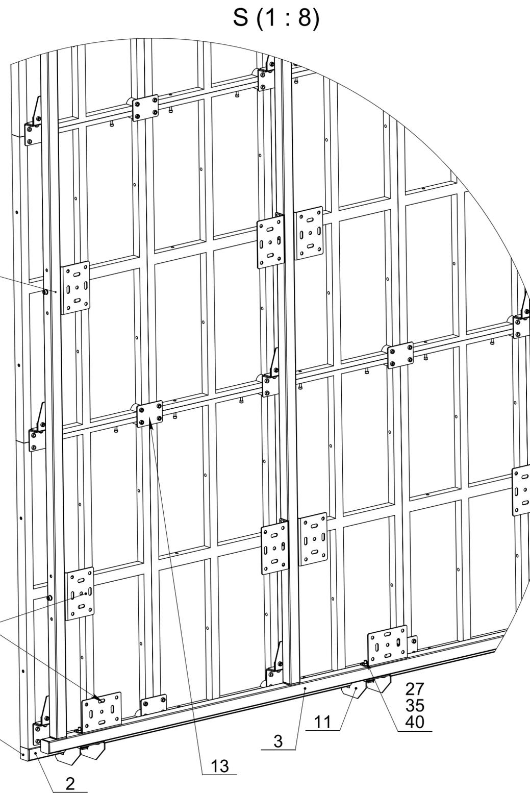
Нижняя сборка труб для облегчения выставления 1 ряда панелей ( после окончательного закрепления всей видеостены возможен демонтаж этих нижних труб.)
