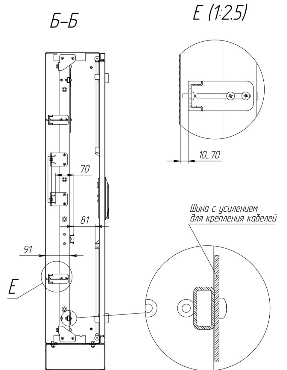
Корпус и дверки шкафа из стали толщиной 1,2 мм
