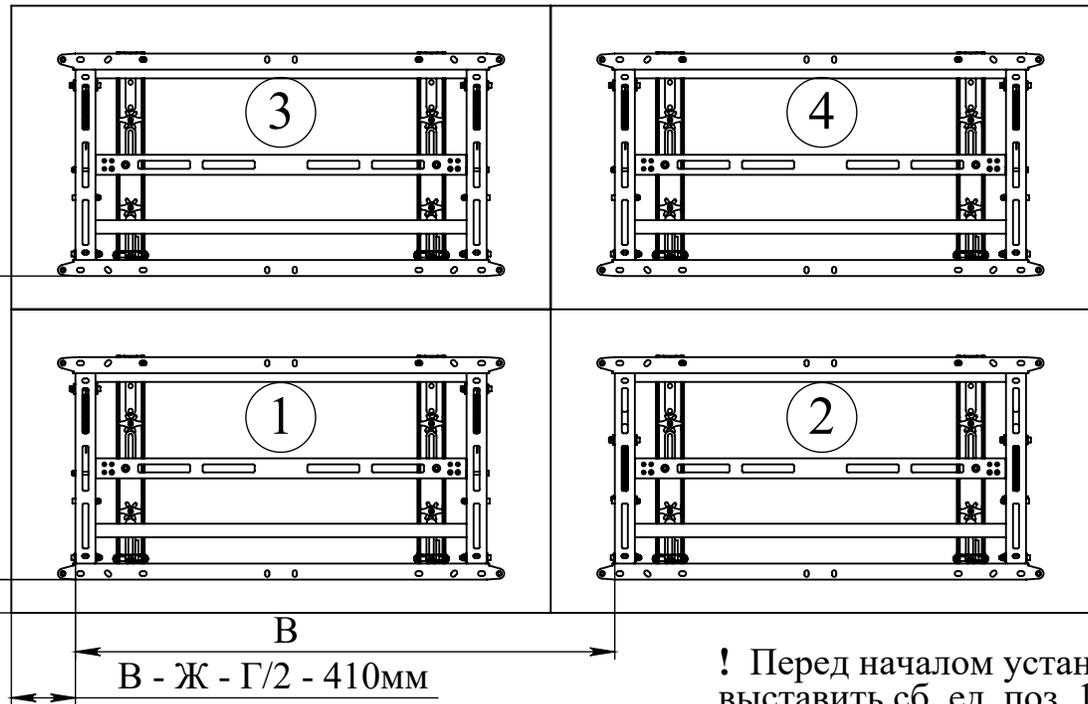
! Перед началом установки панелей выставить сб. ед. поз. 1 в среднее положение (в пазах) при помощи звездочек.
