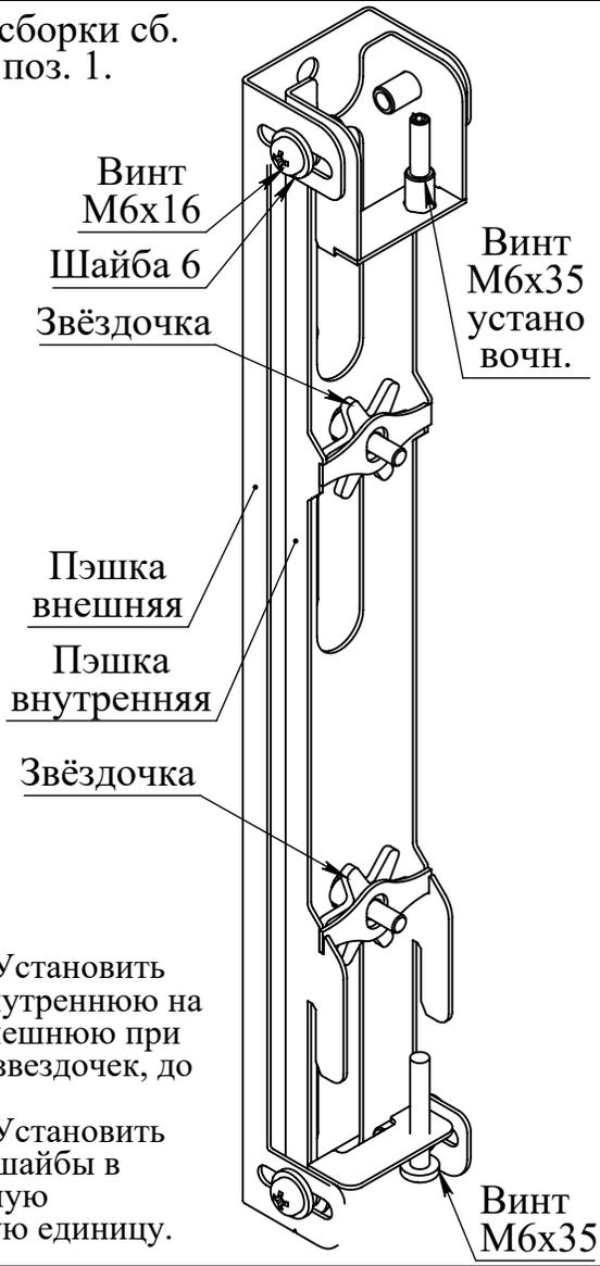
Шаг 1: Установить пэшку внутреннюю на пэшку внешнюю при помощи звездочек, до упора.
