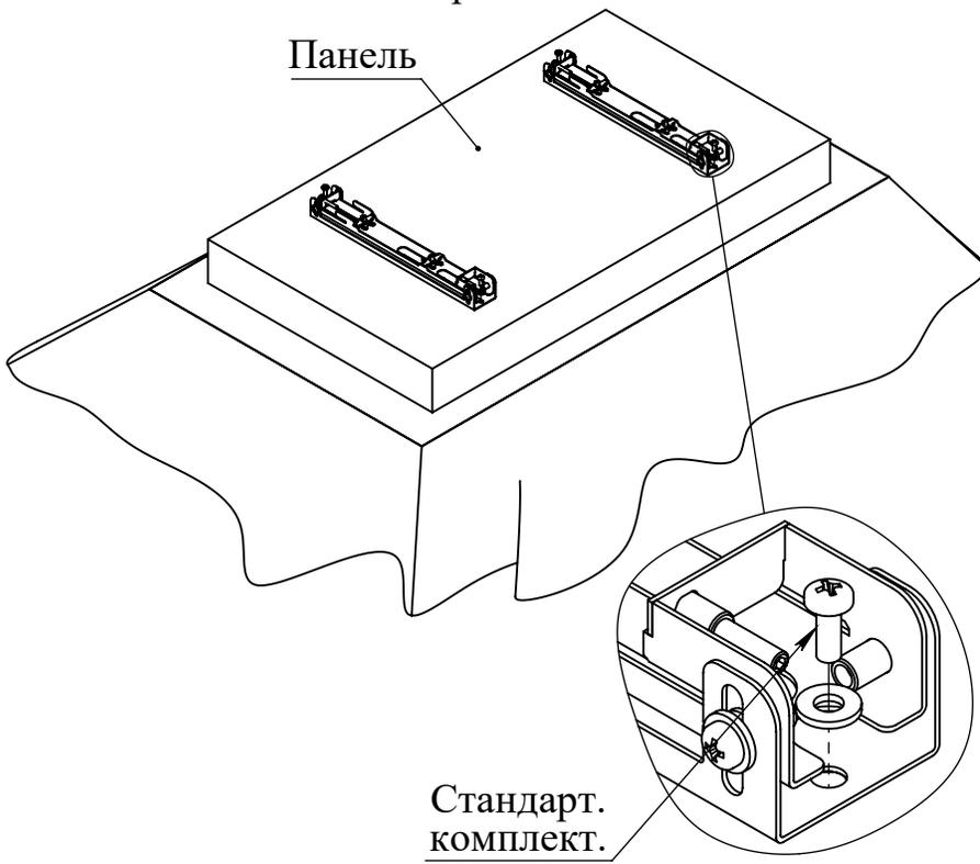
Схема расположения кронштейнов на стене и порядок установки и юстировки панелей.
