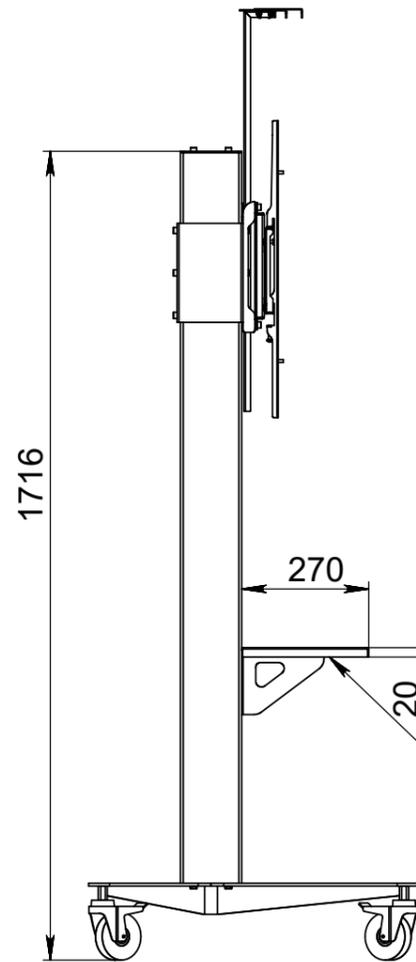
Полка из листового металла толщиной 2мм, отбортовка 20мм
